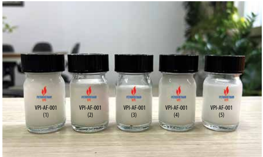
Hình 1. Các hệ hóa chất chống tạo bọt được thử nghiệm tại Trung tâm VPI-Labs
